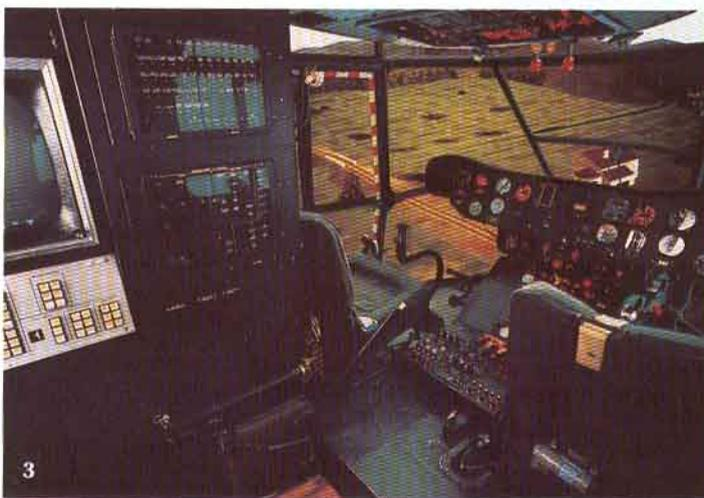
un pilote est assis sur un siège allongé, vêtu d'une combinaison qui se gonfle d'air pour imiter sur son corps la pression due à la vitesse. La « visu » est assurée par plusieurs projecteurs aux objectifs « fish eye » (objectifs couvrant un champ de vision très large) qui produisent un effet 3D très convaincant.
